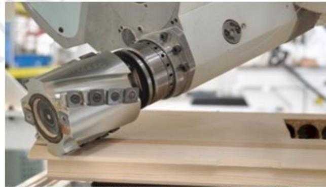
Bild: Abbundportal für Endbearbeitung der Balken und Platten
