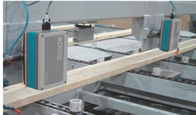
Bild: E-Modul Erkennung für Qualitäts- & Festigkeitssortierung
